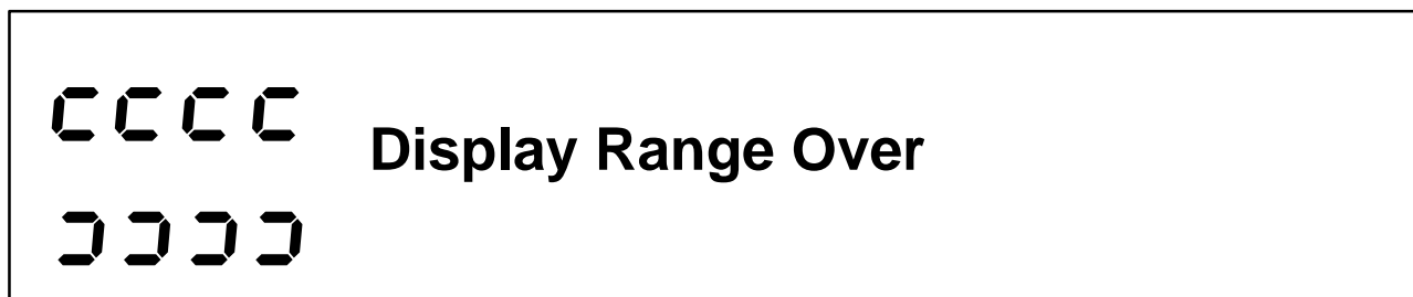
Fig. 7-13. Display Range Over (Error)
